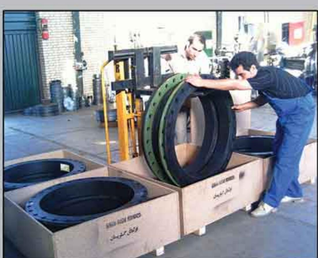
در این روش از ماهیچه های فلزی استفاده گردیده و لرزه گیر لاستیکی پس از پیش فرم بر روی ماهیچه فلزی درون دیگ بخار ( Auto Clave ) قرار گرفته و پخت می گردد .
