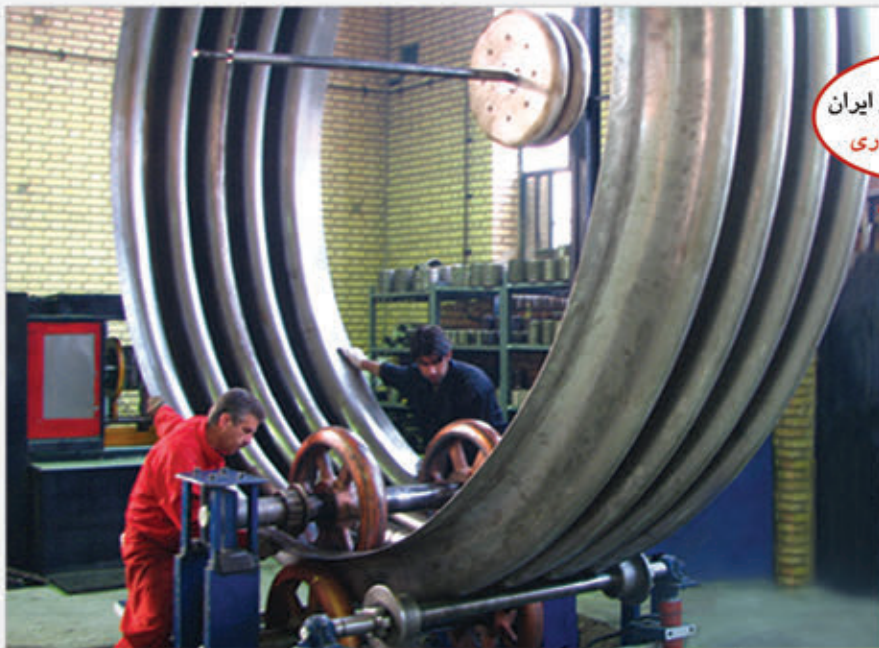
بیلوز آکاردئونی با قطر ۴ متر جهت توربین های گازی زیمنس V 94.2
