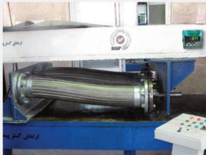
آزمون حرکت تناوبی ( خمش کنسول ) بر روی ۳ عدد شیلنگ سایز ۶ اینچ
