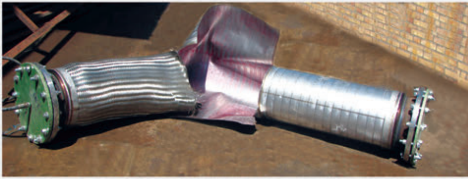
آزمون مخرب تست ترکیدگی با ۴ برابر فشار کاری
