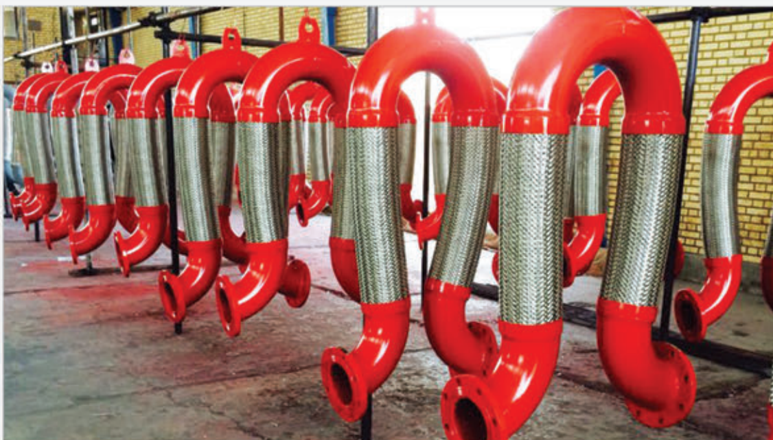
اتصال فلکسیبل U جهت مقاوم سازی مسیر پاپینگ در برابر زلزله
