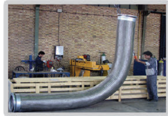
اتصال فلکسیبل خرطومی سایز ۱۶ اینچ جهت مشعل کوره
