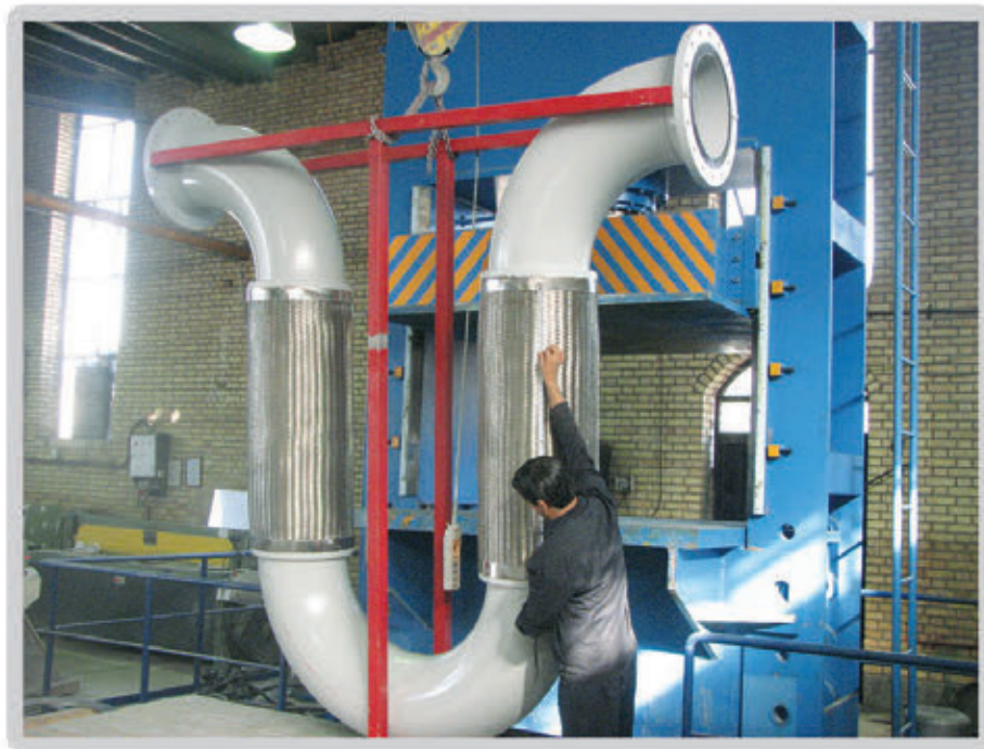
اتصال فلکسیبل U سایز ۱۶ اینچ جهت مقاوم سازی مخازن در برابر زلزله
