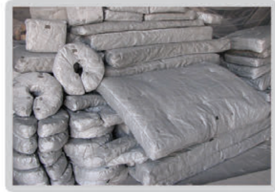
مجموعه بالشتک عایق توربین گازی
