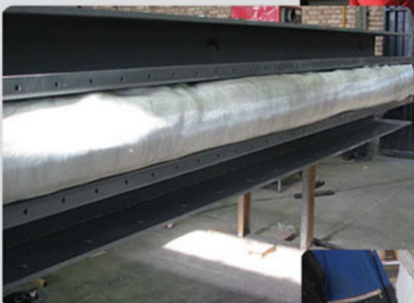
فریم فلزی عایق گذاری شده آماده مونتاز پارچه نسوز <
