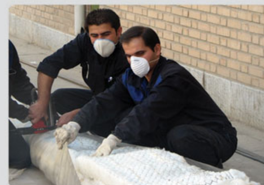
> قرارگیری عایق در توری ریز بافت استیل
