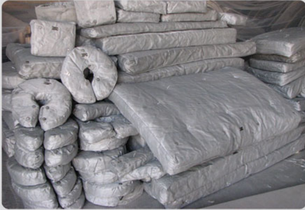
مجموعه بالشتک عایق توربین گازی
