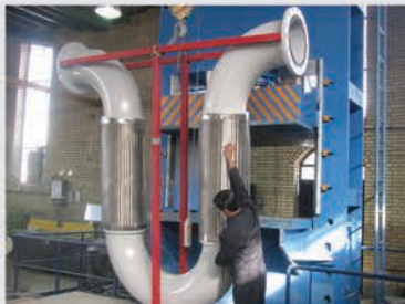
اتصال فلکسیبل ۱۱ سایز ۱۶ اینچ جهت مقاوم سازی مخازن در برابر زلزله
